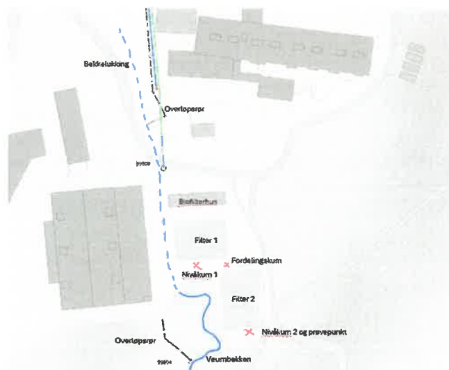
Figur 2. Skjermdump Gemini. Kart over Kvernhusbekken og renseanlegget. Blå stiplet linje indikerer bekkelukking der vannet i bekken ledes gjennom et rør under bakken. Lenger ned åpnes bekken og fortsetter nedover mot Veumbekken.
